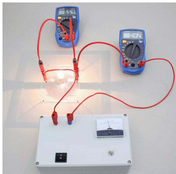
Abb. 5 mögliche Schaltung zur Bestimmung der Kennlinie im Realexperiment
